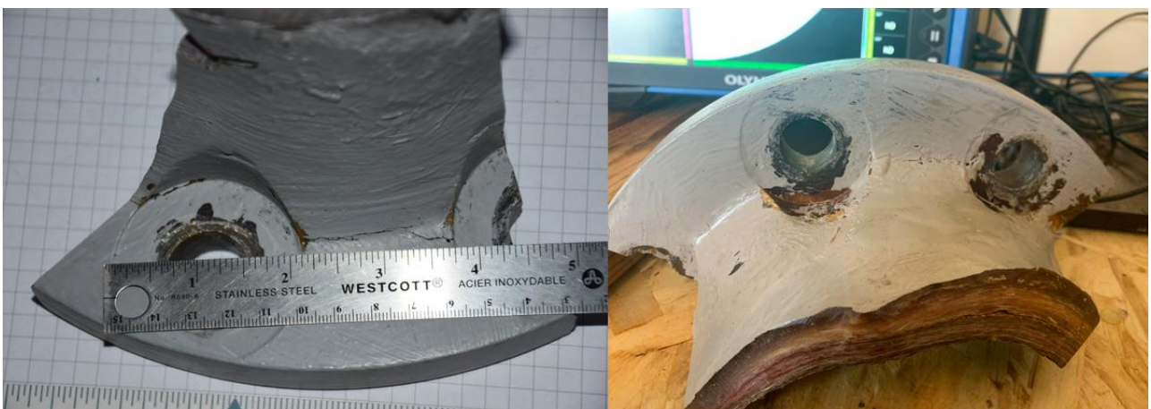
Figura 2. Cricca tra fori di bulloni in un campione sezionato di una flangia in FRP
